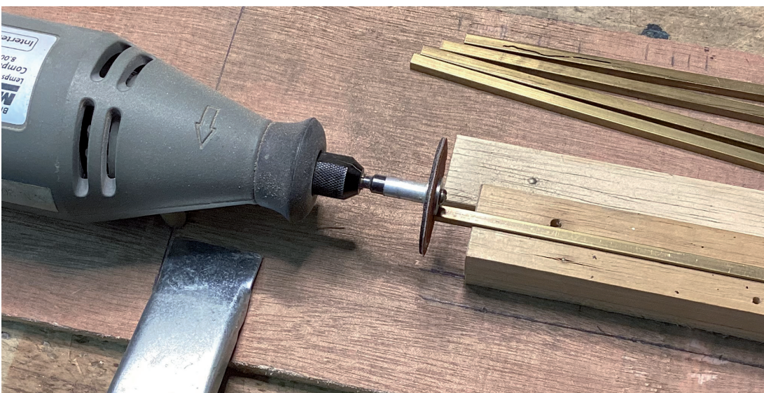
Het vlak slijpen van de kopse kanten van de liggers.
